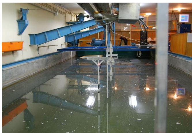
Rysunek 5-35 Stanowisko do pomiaru amplitudy oraz kształtu impulsów sondujących wraz z odległością (po lewej) laserowy miernik do określenia odległości hydrofonu od przetwornika (po prawej)
