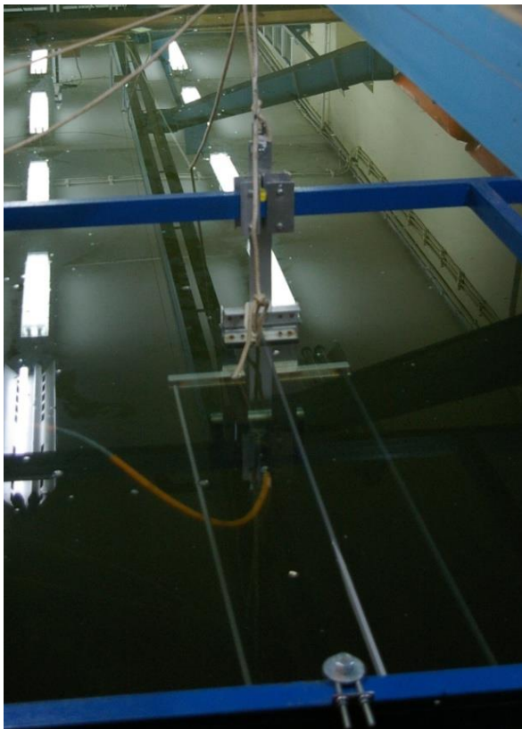
Rysunek 5-20 Antena echosondy parametrycznej na stelażu
