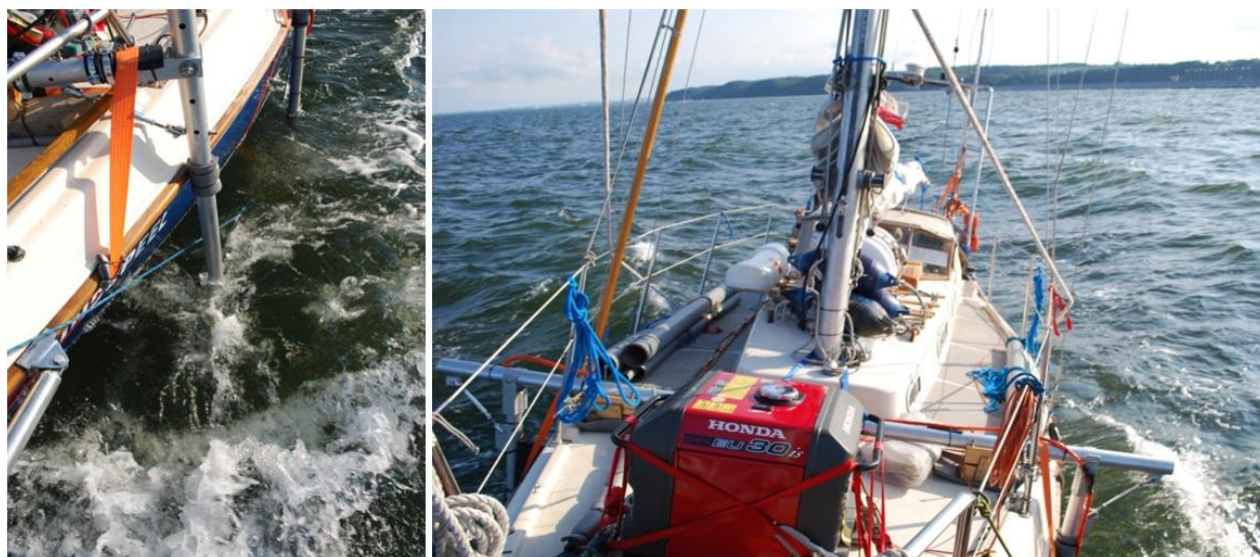
Rysunek 5-71 Uchwyt echosondy wielowiązkowej (po lewej stronie), agregat zainstalowany na dziobie jednostki pomiarowej (po prawej stronie)
