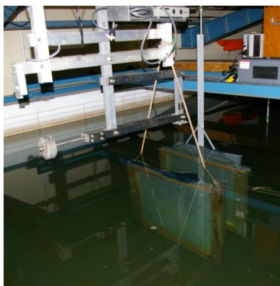
Rysunek 5-55 Pomiar dynamiczny rozdzielczości wgłębnej – rozpoczęcie procesu dynamicznego odsuwania ramki z osadem.
