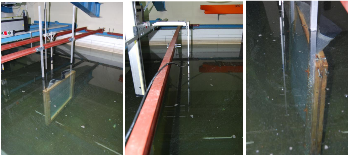
Rysunek 5-48 Konfiguracja stanowiska pomiarowego do określenia współczynnika tłumienia – patrząc od lewej strony: model wypełniony mułem, pomiar tła i ramka z piaskiem o grubości 10 cm
