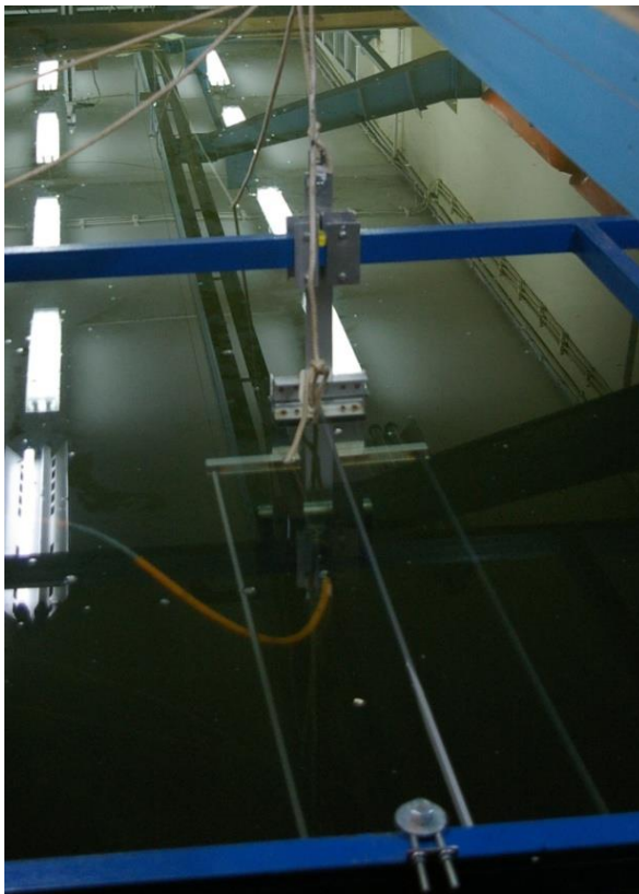
Rysunek 5-20 Antena echosondy parametrycznej na stelażu
