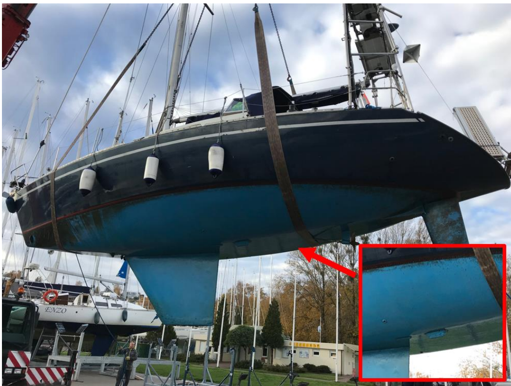
Rys. 5.65 Wskazanie punktu montażowego w kadłubie przetwornika sonaru bocznego
