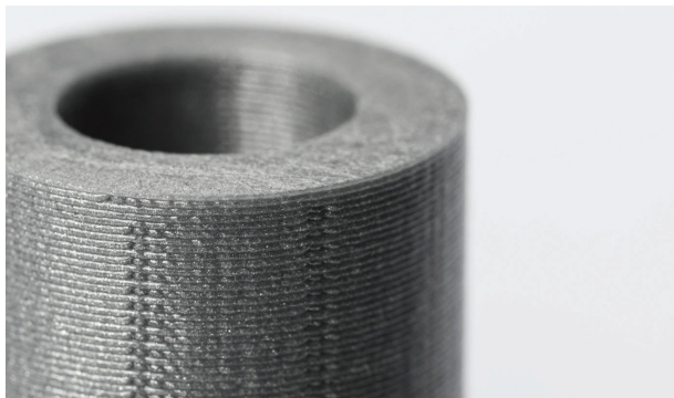
Rys. 4. Element z widocznymi charakterystycznymi liniami łączenia poszczególnych warstw materiału
