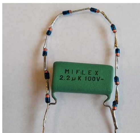
Rys. 42. Modelowy układ elektryczny złożony z kondensatora i połączonych z nim równolegle 10 diod.
