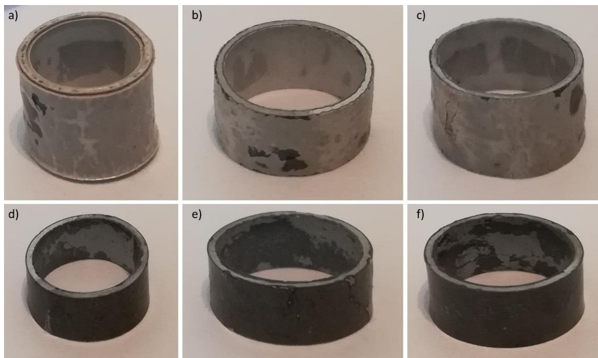
Rysunek 4.17 – Zdjęcia próbek poddanych utlenianiu w 1273 K i chłodzonych do temperatury pokojowej odpowiednio w: a) powietrzu, b) wodzie, c) komercyjnym oleju syntetycznym oraz w 1373 K i chłodzonych do temperatury pokojowej odpowiednio w: a) powietrzu, b) wodzie, c) handlowym oleju syntetycznym.
