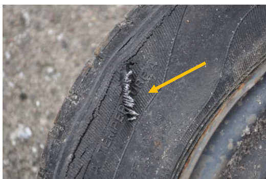
Rys. 4.25. Uszkodzone boku opony samochodu
