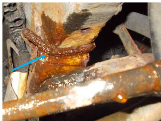
Rys. 5.11. Widoczny skorodowany przewód hamulcowy z którego wycieka płyn
