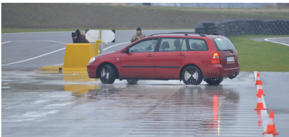
Rys. D.10. Widok samochodu po zatrzymaniu się na płycie poślizgowej (kąt odchylenia osi tylnej od pierwotnego kierunku jazdy wynosił prawie 270^\circ )
