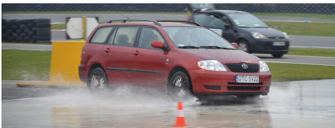
Rys. D.12. Widok samochodu po zjeździe z „płyty dynamicznej” po zaburzeniu ruchu osi tylnej
