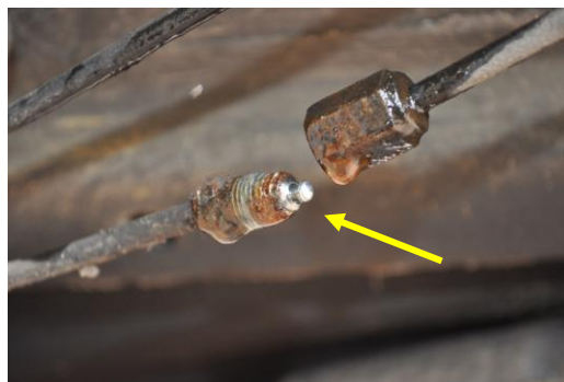
Rys. 4.92. Rozłączony przewód hamulcowy w którym znajdował się nit zaślepiający
