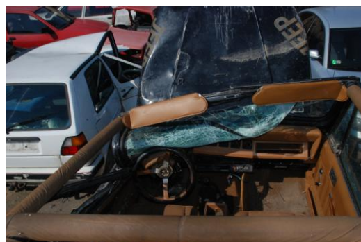
Rys. 4.98. Widok wnętrza samochodu terenowego Jeep po dachowaniu
