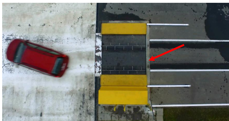
Rys. D.4. Samochód zjechał z „płyty dynamicznej” – płyta po zakończeniu przesuwania w lewą stronę
