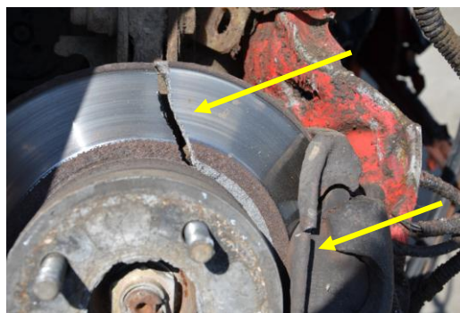
Rys. 4.34. Uszkodzona tarcza hamulcowa i osłona zacisku koła samochodu Fiat
