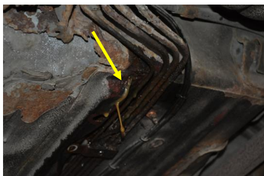
Rys. 4.57. Widoczny wyciek płynu hamulcowego z metalowego przewodu
