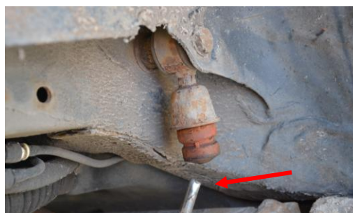
Rys. 4.29. Urwane tłoczisko amortyzatora tylnego prawego w samochodzie Renault
