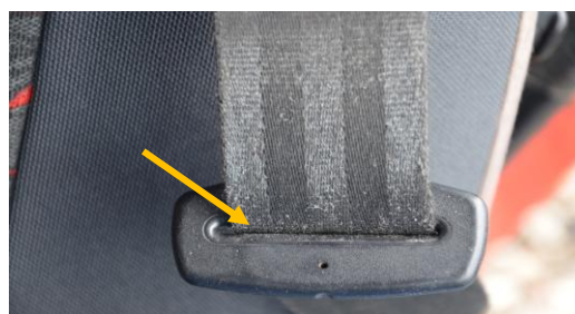
Rys. 4.19. Ślady na taśmie pasa i przelotce zaczepu powstałe wskutek silnego szarpnięcia pasa przy zablokowanej szpuli
