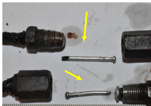
Rys. 4.96. Fragmenty rozłączonych przewodów, w których znajdowały się aluminiowe nity
