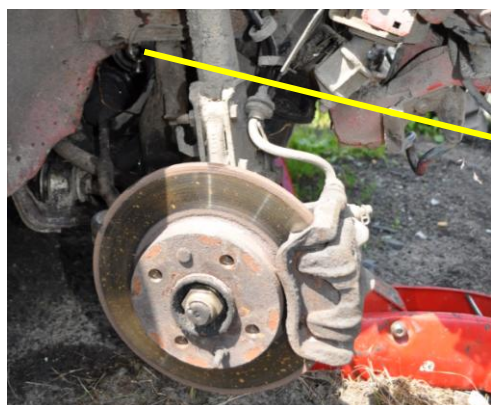
Rys. 4.45. Widoczny wyciek płynu hamulcowego z metalowego przewodu
