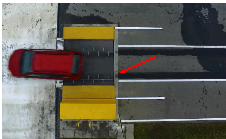
Rys. D.3. Tylna koła samochodu jeszcze nie zjechały „płyty dynamicznej” – końcowa faza przesunięcia płyty
