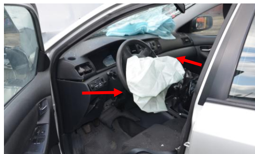
Rys. 4.21. Wystrzelona poduszka powietrzna kierowcy i pasażera w samochodzie Toyota
