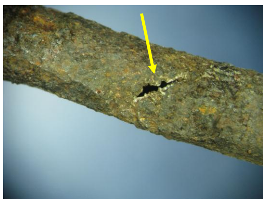
Rys. 4.47. Fragment przewodu hamulcowego z widocznym uszkodzeniem
