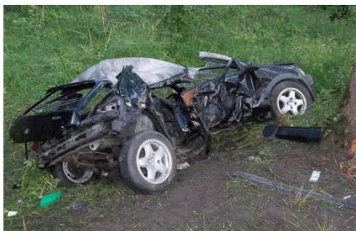
Rys. 4.79. Widok uszkodzonego samochodu Peugeot po uderzeniu boku w drzewo (Rys. źródło http://expresskaszubski.pl )
