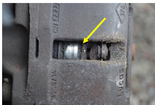
Rys. 4.70. Brak klocka hamulcowego, spowodował docisk tłoczka do tarczy
