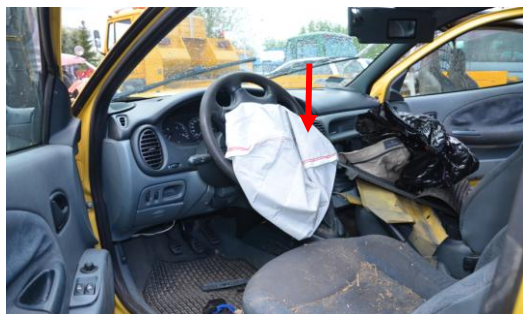
Rys. 4.20. Wystrzelona poduszka powietrzna kierowcy w samochodzie Renault
