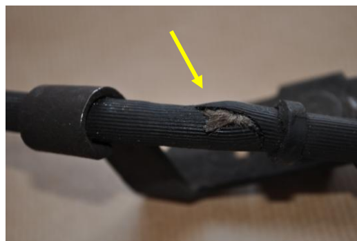
Rys. 4.62. Pęknięcie elastycznego przewodu hamulcowego
