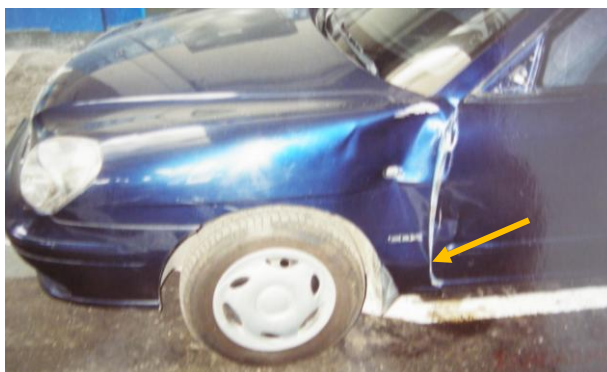
Rys. 4.14. Uszkodzenie błotnika samochodu Daewoo przez chłopca wbiegającego na jezdnię za piłką (zdjęcie skopiowane z akt sprawy prowadzonej przez biegłego)
