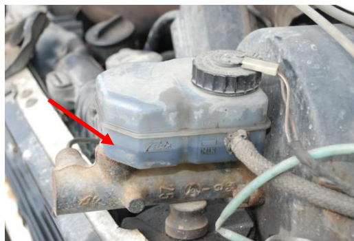
Rys. 4.104. Poziom płynu hamulcowego poniżej oznaczenia „min”
