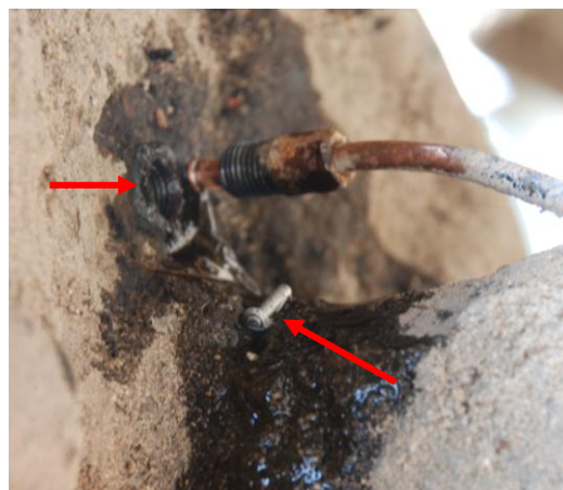
Rys. 4.102. Aluminiowy nit „zaślepiający”, który wypadł z przewodu hamulcowego
