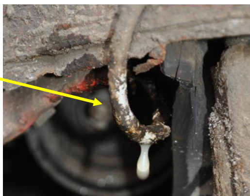
Rys. 4.46. Widoczny wyciek płynu hamulcowego z metalowego przewodu
