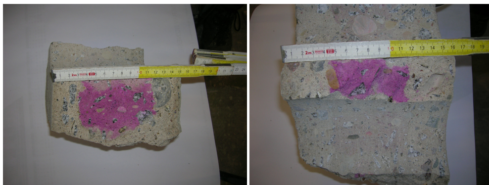
Rysunek 5. Badanie głębokości karbonatyzacji
