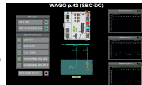
Rys. 8. Ekran panelu operatorskiego sterownika SBC-DC w systemie SCADA
