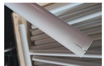
Фиг.11. Спукан заваръчен шев
