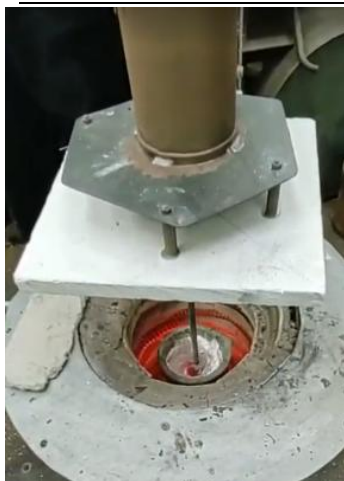
Фиг. 1. Хомогенизация на Ca въведен в съпротивителна пещ
