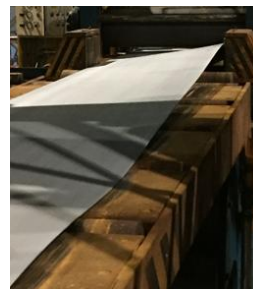
Фиг. 3 Пулса с дефект „вълна“
