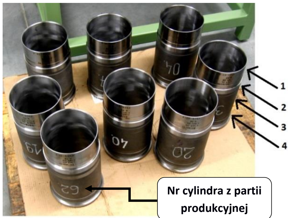
Rys. 119. Miejsca wykonywania pomiarów średnicy i odchyłki kształtu walcowości gładzonej tulei o zmiennej grubości ścianki (grubość g_1 < g_3 < g_2 < g_4 )
