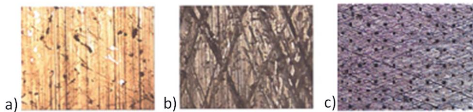
Rys. 8. Przykład tekstur cylindra z kątem gładzenia: a) 45^\circ , b) 140^\circ , c) powierzchnia gładzona z siatką zasobników punktowych wykonanych za pomocą lasera [149]
