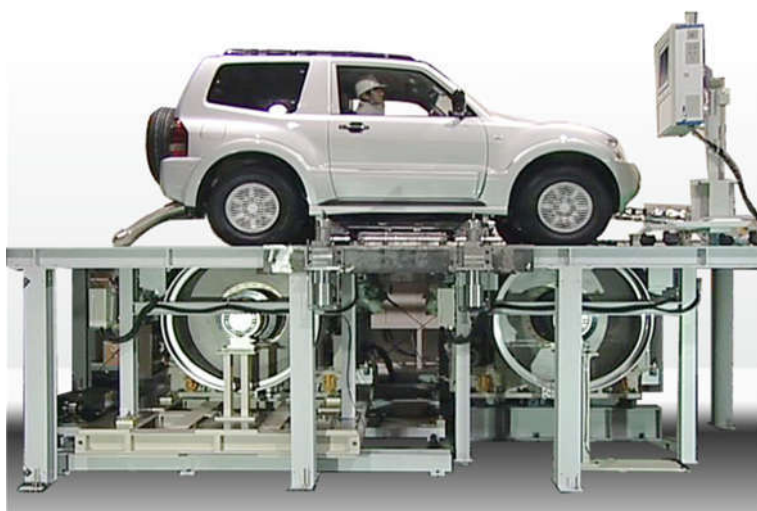
Rys. A.5. Hamownia podwoziowa do pojazdów z napędem na 4 koła firmy Onosokki [146].
