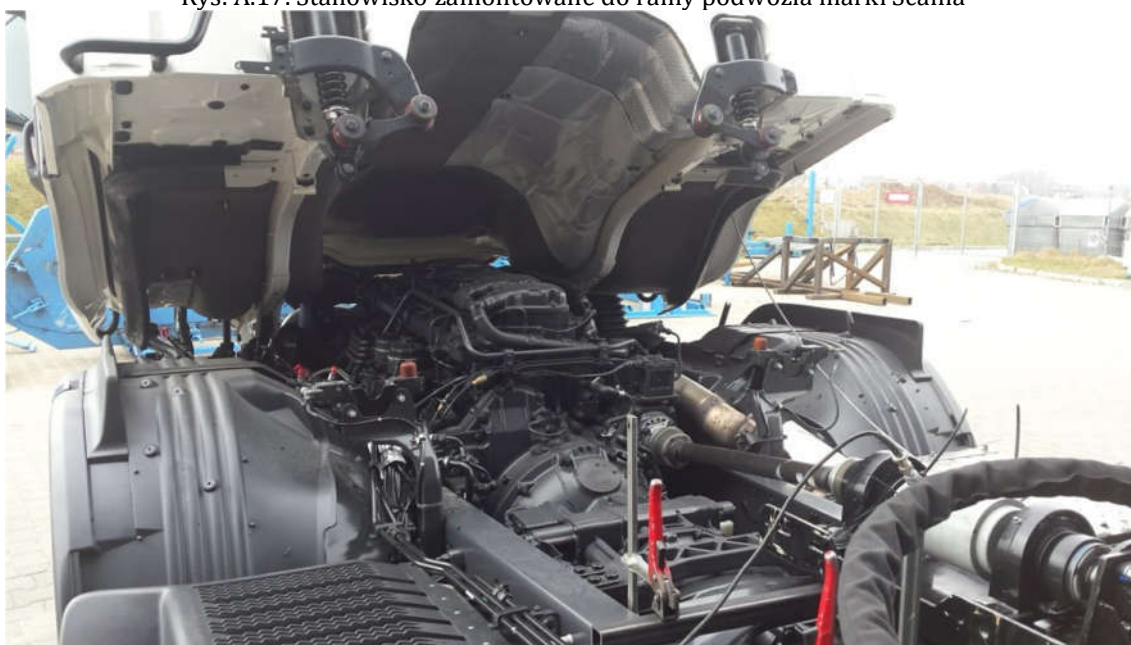
Rys. A.18. Silnik Scania podczas testów. Uniesiona kabina kierowcy w celu lepszego chłodzenia silnika
