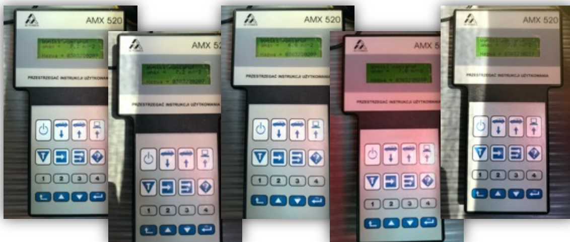
Rys. C.1. Wartości opóźnienia hamowania z 5 pomiarów wykonanych dla Volvo PV544 z 1961 r.
