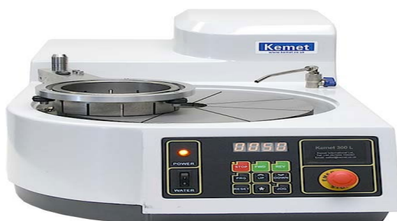
Rys. 2.7. Docierarka jednotarczowa Kemet - model 300 L [93]
