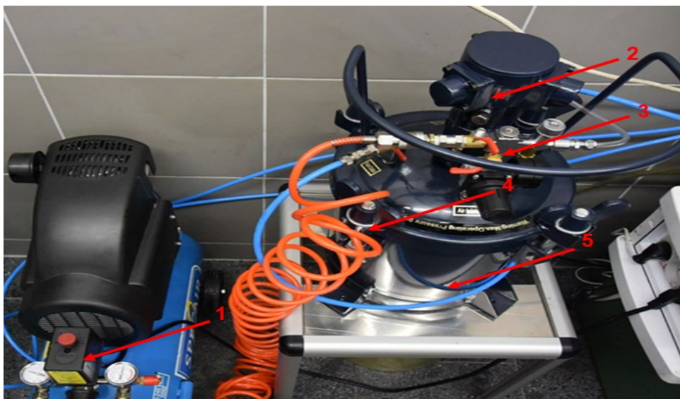
Rys. 5.9. Elementy wymuszonego układu dozowania (1-kompresor, 2-napęd wirnika mieszadła, 3-regulator ciśnienia wewnątrz zbiornika, 4-pokrywa zbiornika wraz z elementami mocującymi)
