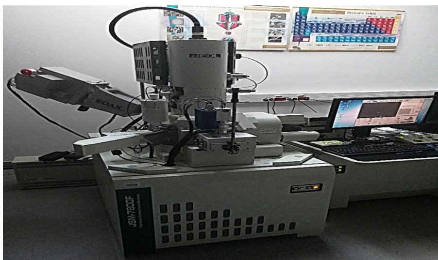
Rys. 5.24. Mikroskop skaningowy JOEL JSM-7800F [103]
