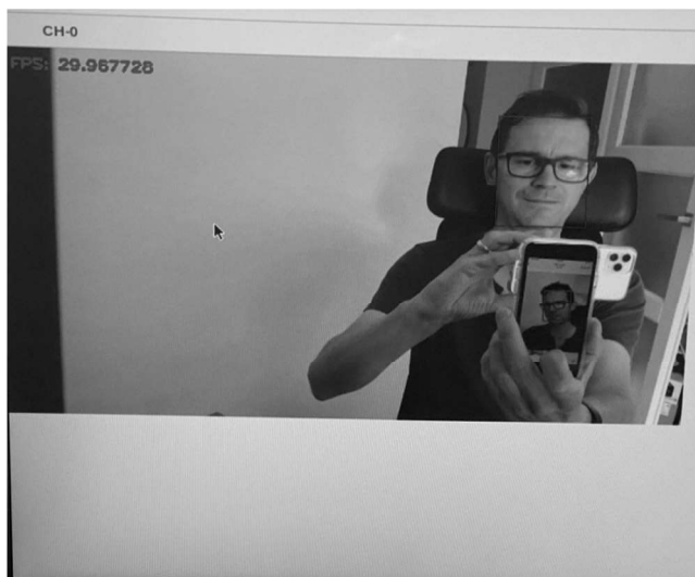
Rys. 7. Rezultat wykrywania twarzy algorytmem densebox wykonywanym na sprzętowym DPU w FPGA
