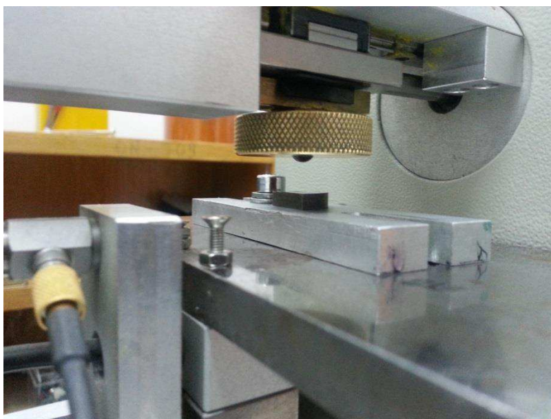
Rys. 46. Widok głowicy badawczej tribotestera Ducom TR-28M (ITME)
