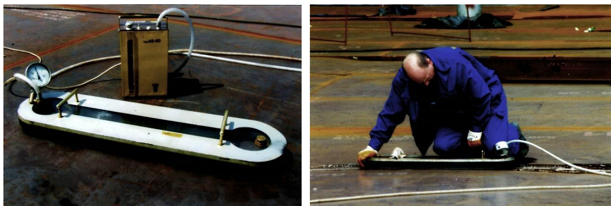
a b Rys. 1.30. Badania szczelności spoin dna zbiornika metodą próżniową: a – widok sprzętu badawczego, b – proces sprawdzania szczelności
