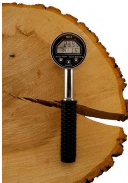
Rys. 2.1. Wilgotnościomierz HIT - 3 produkcji TANEL Elektronika i Informatyka Sp.J. ( https://www.alphaomega-electronics.com/4597-large_default/hit-3-wood-moisture-meter.jpg )
