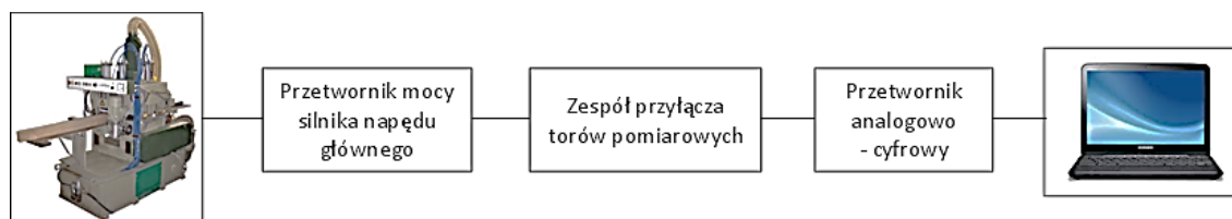
Rys. 7.12. Schemat blokowy stanowiska badawczego (opracowanie własne)
