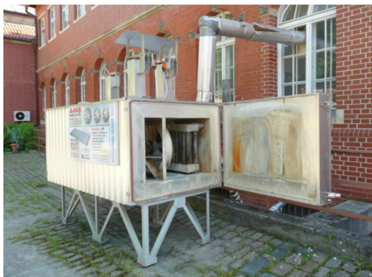
Rys. 7.8. Doświadczalna suszarnia półprzemysłowa zaprojektowana na PG: a) widok z góry, b) widok z boku, c) widok od strony komory suszarniczej, d) widok od tyłu (a) i b) Barański 2018; c) i d) Barański i in. 2013)
