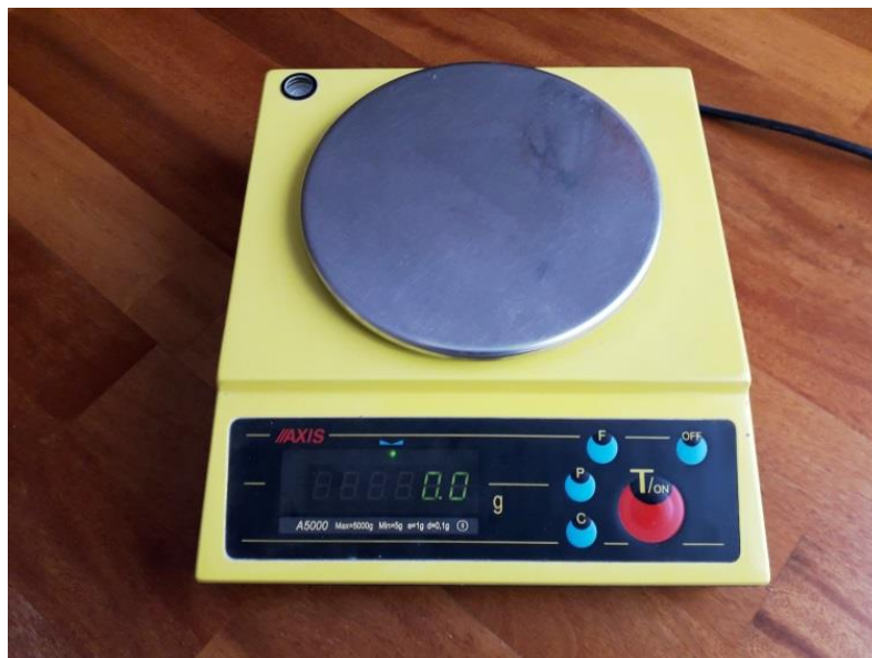
Rys. 7.4. Waga elektroniczna AXIS typu A5000 (zdjęcie własne)
