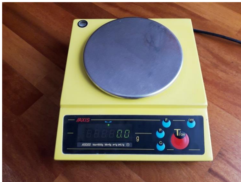
Rys. 7.4. Waga elektroniczna AXIS typu A5000 (zdjęcie własne)
