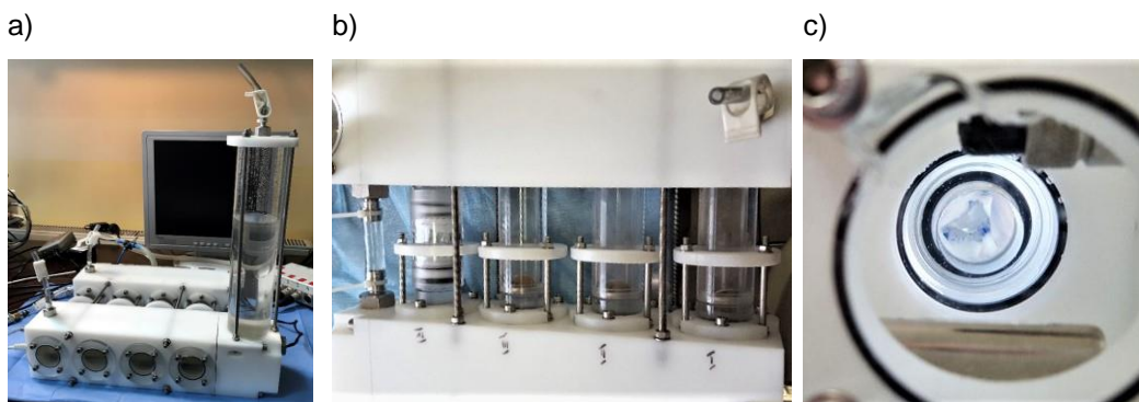
Rys. 10.1. Stanowisko do badań protez zastawek w FRK a) widok ogólny b) przestrzenie pomiarowe c) widok przez wizjer umieszczony na głównej osi przepływu przez badaną protezę
