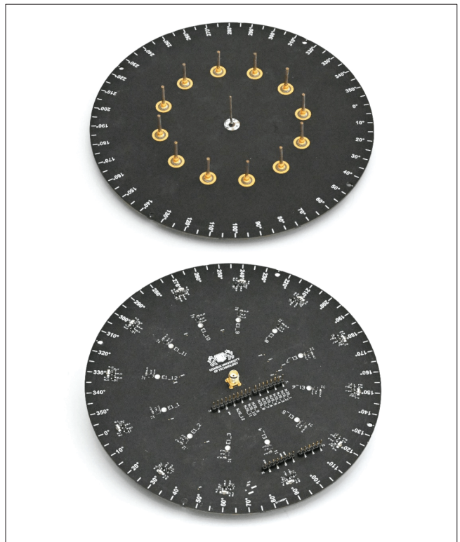
■ Rys. 3. Wytworzony prototyp (góra i dół) anteny typu ESPAR przeznaczony do integracji wewnątrz stacji bazowej pracującej w systemie Bluetooth Low Energy
