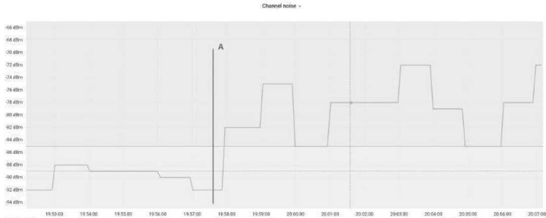
Rys. 5. Wizualizacja parametru channel noise pokazująca powód spadku przepływności połączenia testowego
