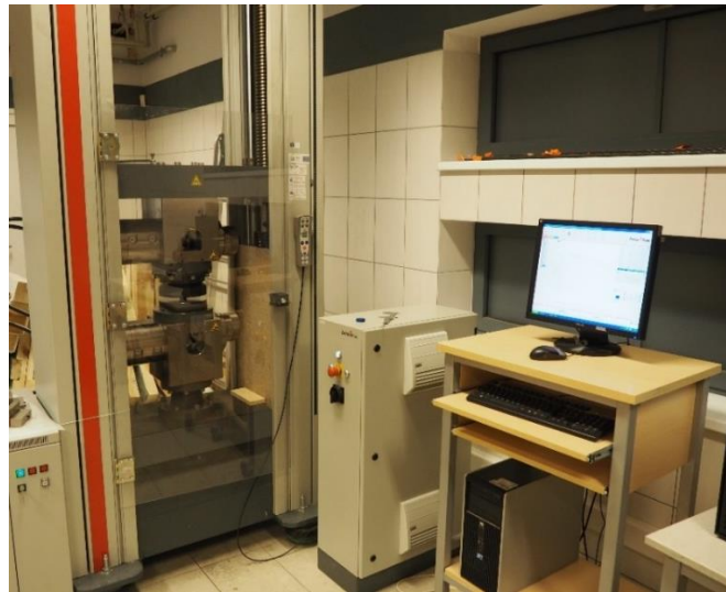
Rys. 59. Stanowisko badawcze do jednoosiowej próby ściskania
