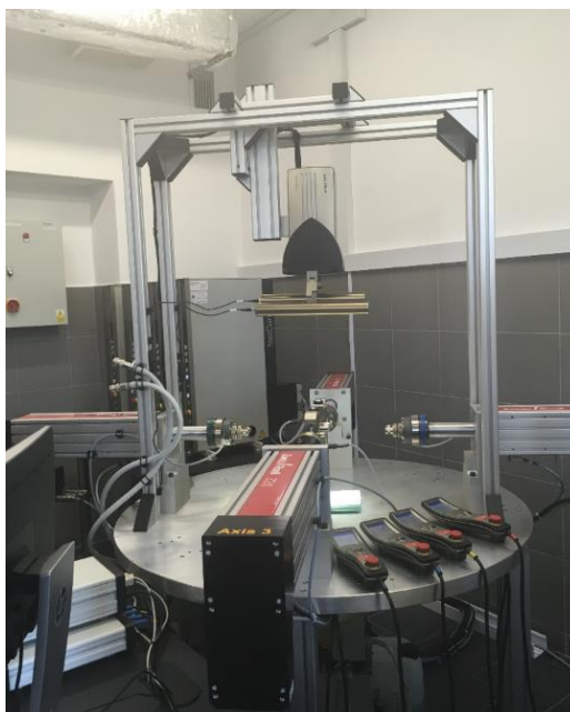
Rys. 30. Stanowisko do badań wytrzymałościowych dwuosiowych – maszyna Biaxial 2kN Zwick
