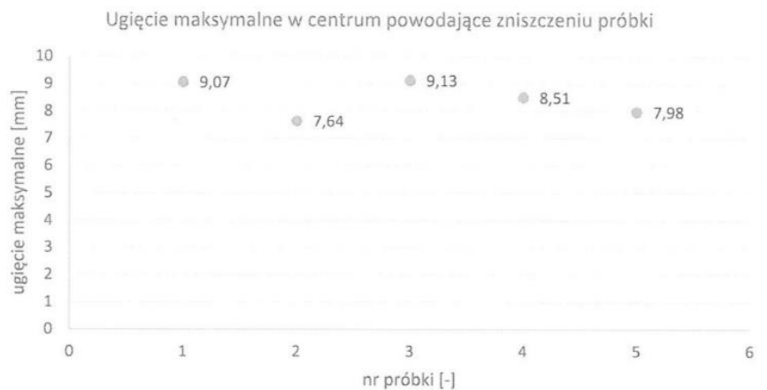
Rys. 129. Wykres ugięcia maksymalnego próbki okrągłej powodujące jej zniszczenie - źródło [50]
