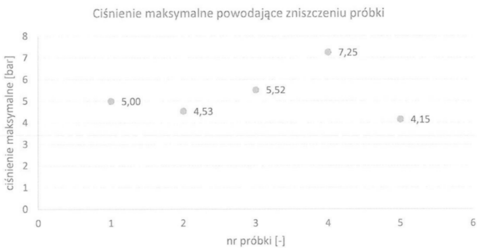
Rys. 131. Wykres ciśnienia maksymalnego powodującego zniszczenie próbki okrągłej - źródło [50]
