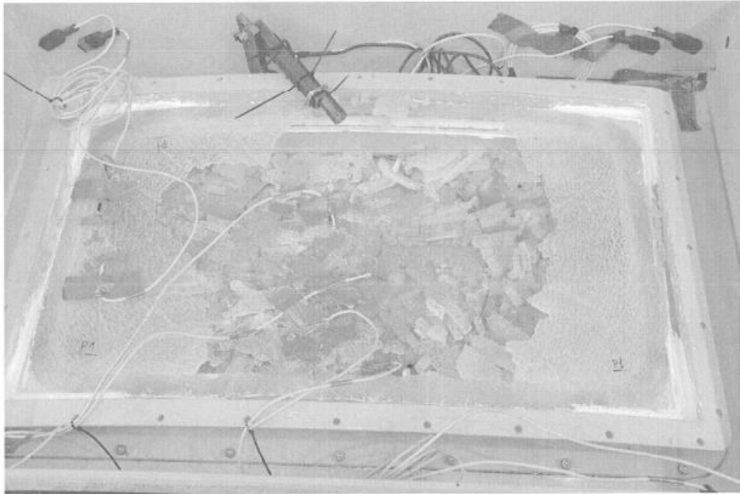
Rys. 134. Fotografia zniszczonej próbki prostokątnej - źródło [50]
