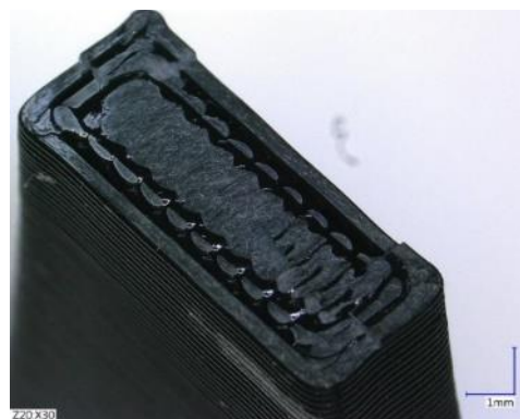
Rys. 67. Złom próbki wydrukowanej w orientacji Z
