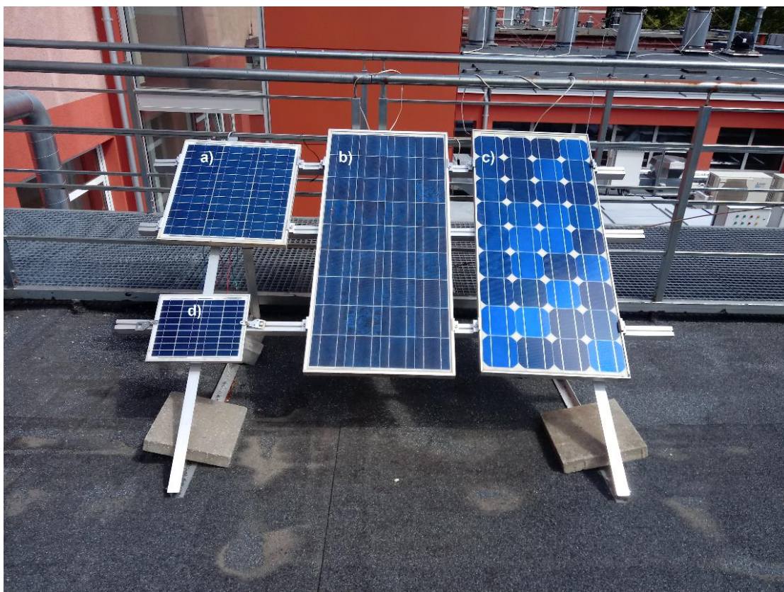
Rys. 5.1.1. Moduły fotowoltaiczne zastosowane w badanie osadu naturalnego: a) MWG-30, b) AP-7105, c) STP-085, d) CL010-12P
