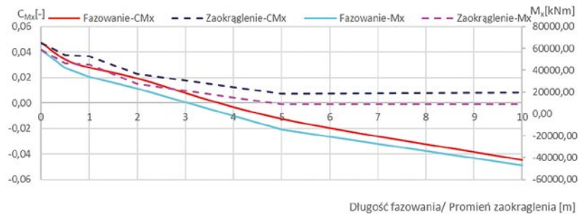
Rys. 20. Zmiana współczynnika aerodynamicznego momentu w zależności od wielkości fazowania/zaokrąglenia dla rotacji względem osi X
