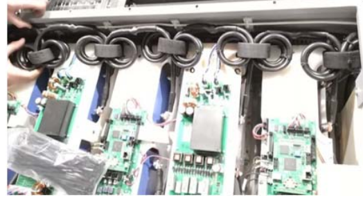
Rys.2. Przykład zastosowania dławików common-mode na wyjściu każdego mostka w wielopoziomowym przekształtniku kaskadowym SiC do napędu trakcyjnego zasilanego z sieci 3kV DC
