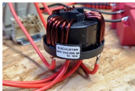
Rys. 14. Dławik CM o indukcyjności L_{CM}=3,1mH badany na stanowisku laboratoryjnym z opracowanym falownikiem SiC pracującym w napędzie wysokoobrotowym
