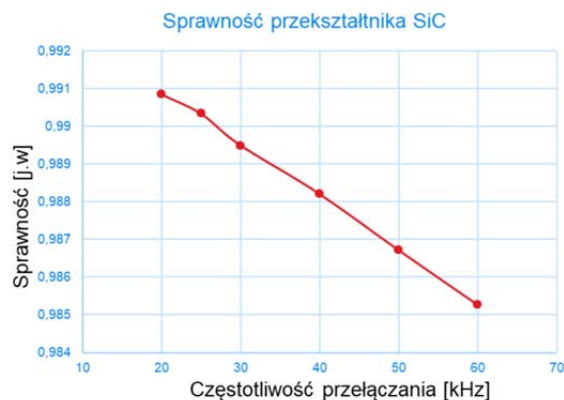
Rys. 4. Charakterystyka sprawności 3-gałęziowego falownika SiC w funkcji częstotliwości przełączania tranzystorów przy obciążeniu prądem znamionowym tranzystorów SiC MOSFET równym 30A
