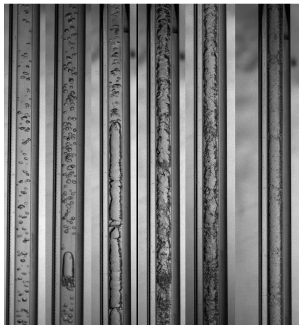
Rysunek 4: Struktury przepływu P_{zr}=0,4 G=355 \text{ kg}/(\text{m}^2 \cdot \text{s}) stopnie suchości kolejno: 3,1%, 4,2%, 10%, 23,1%, 80,5%
