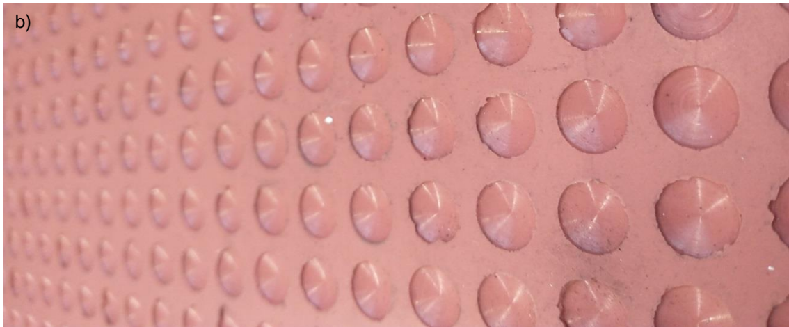
Rys. 68 Forma do wykonania wzorcowej nawierzchni referencyjnej: a) cała forma, b) powiększony fragment formy.
