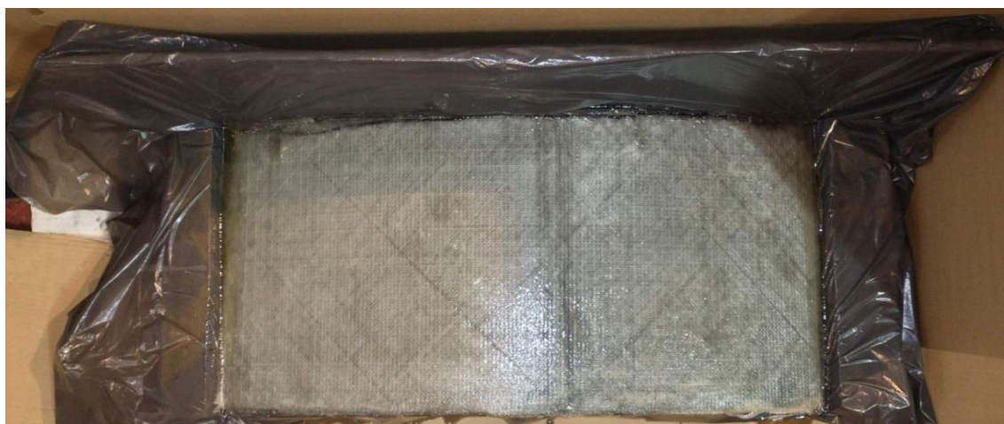
Rys. 81 Forma wewnętrzna pokryta matą szklaną i nasączona żywicą epoksydową.
