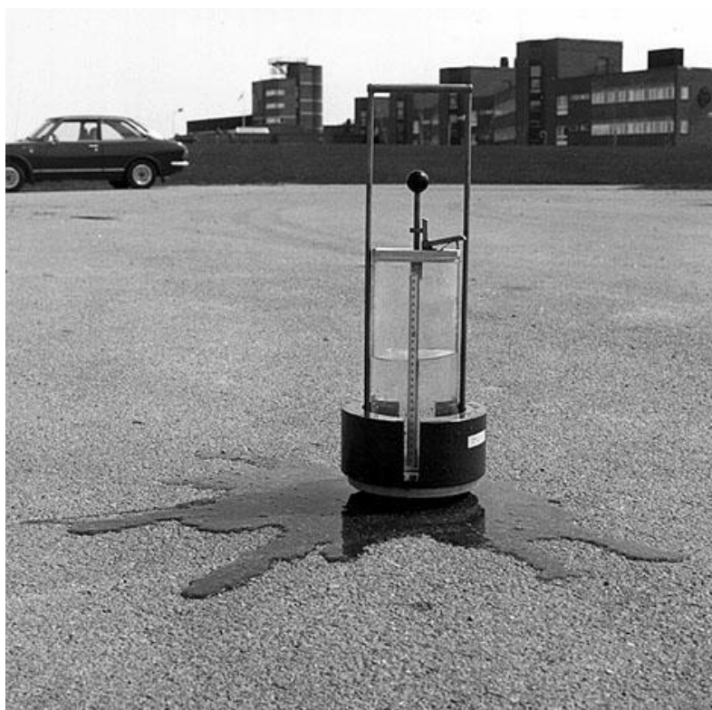
Rys. 15 Pomiar tekstury nawierzchni metodą wypływu cieczy [46].
