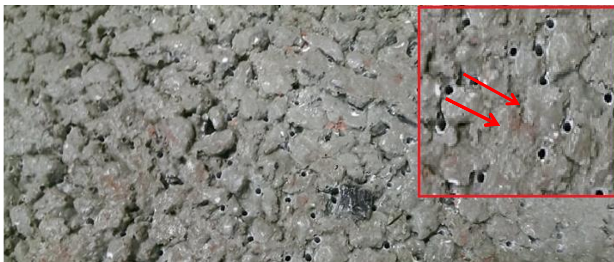
Rys. 48 Replika nawierzchni SMA8 z otworami odpowietrzającymi.
