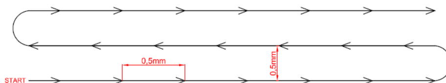
Rys. 41 Schemat poruszania się czujnika laserowego.
