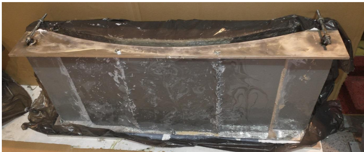
Rys. 82 Połączona i uszczelniona forma.
