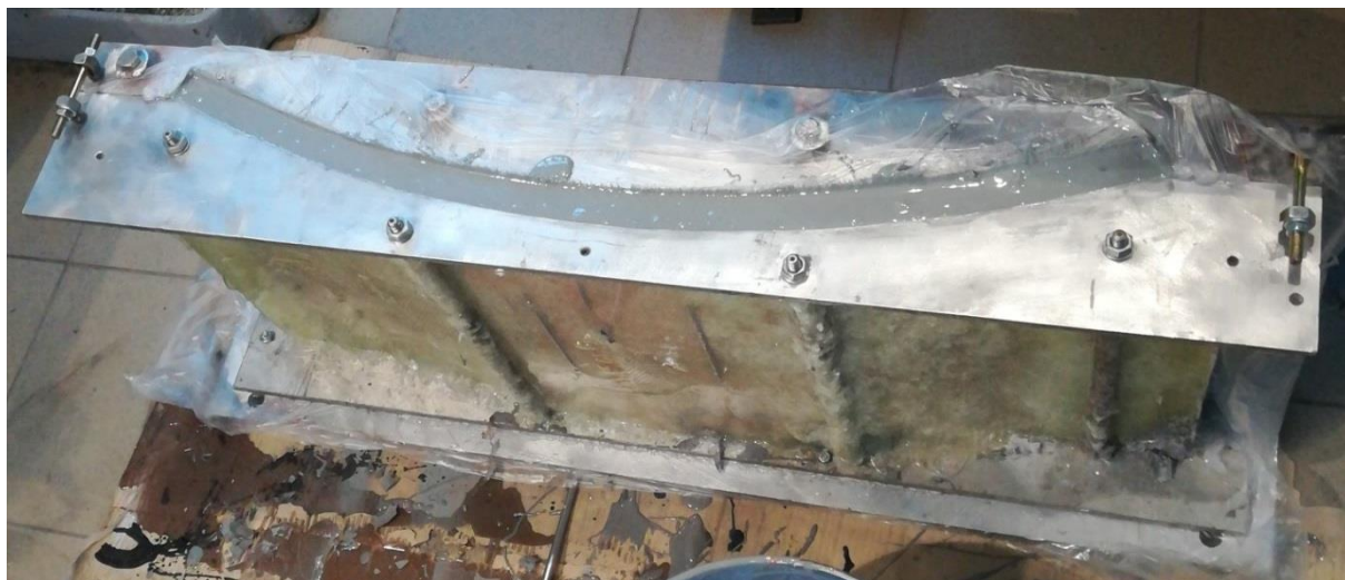
Rys. 83 Forma wypełniona żywicą odlewniczą.
