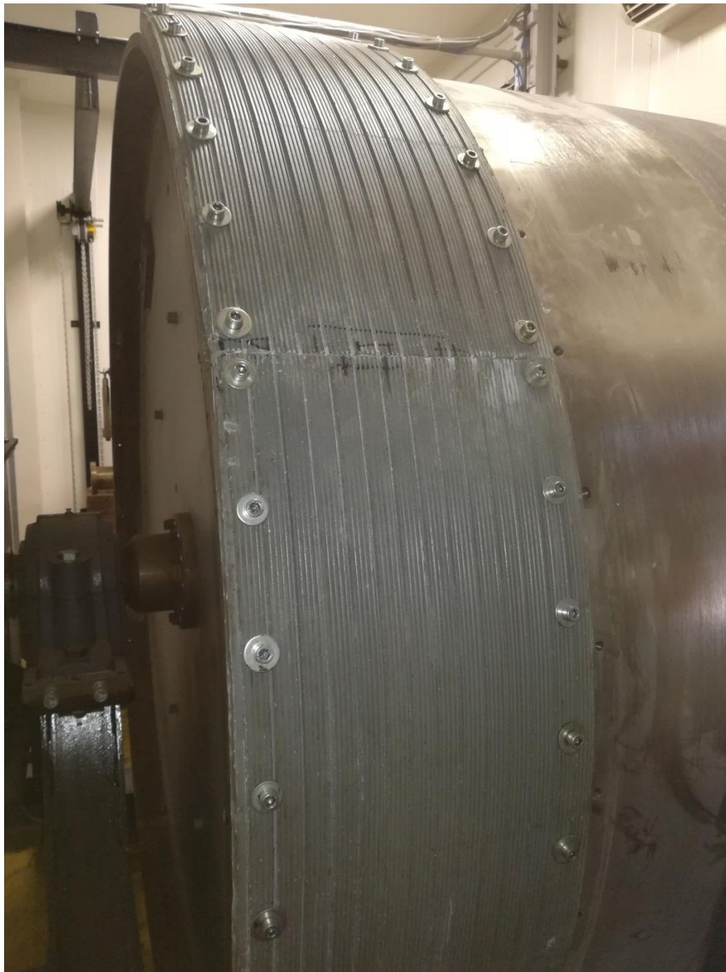
Rys. 86 Segmenty nawierzchni doświadczalnej zamontowane na bębnie maszyny bieżnej.
