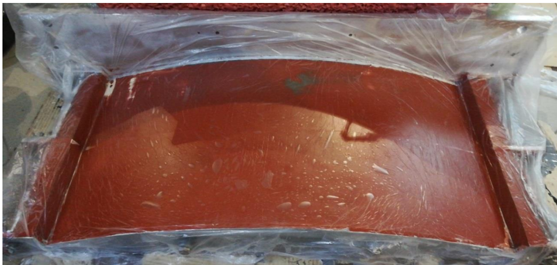
Rys. 80 Forma wewnętrzna pokryta folią.
