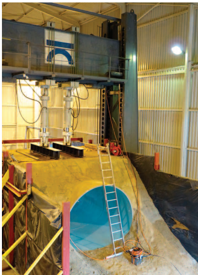
Fot. 3 Zabudowany model z konstrukcją przekazującą obciążenia
