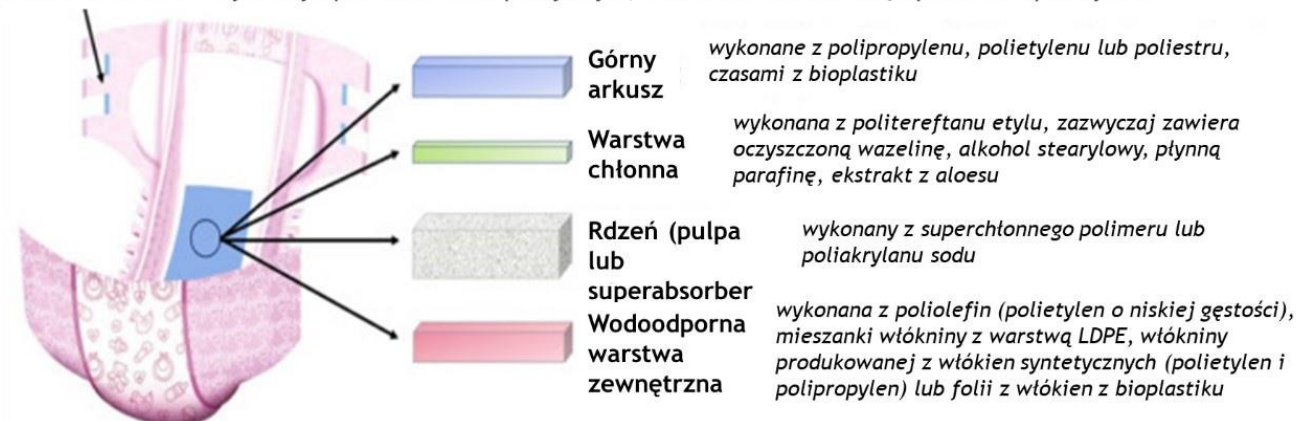
Rysunek 1. Schemat budowy jednorazowej pieluchy dziecięcej
