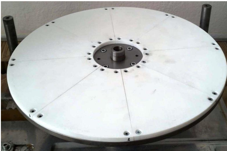
Rysunek 33. Stanowisko badawcze do docierania jednostronnego powierzchni płaskich: a) widok ogólny segmentów ściernych przykręconych do metalowego korpusu urządzenia; b) widok na górną powierzchnię PO umieszczonych w separatorze przedmiotowym wewnątrz pierścienia prowadzącego: 7 – próbki obrabiane z \text{Al}_2\text{O}_3 , 8 – separator przedmiotowy
