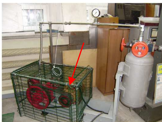
Rys. Z3.1. Widok stanowiska laboratoryjnego sprężarki tłokowej przed (a) i po modernizacji (b) – zmiana średnicy koła napędowego silnika elektrycznego
