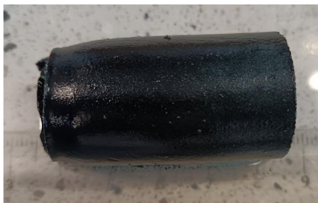
Rysunek 9.15 Przykładowy hydrożel zredukowanego tlenku grafenu z cząstkami prekursora NVP, otrzymany podczas syntezy hydrotermalnej.
