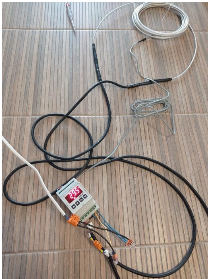
Rysunek 37. Testy przewodu grzejnego i regulatora
