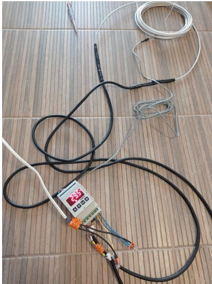
Rysunek 37. Testy przewodu grzejnego i regulatora
