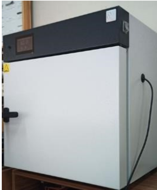
Rysunek 27. Stanowisko badawcze. Do ciepłarki od prawej strony przez izolowaną termicznie śluzę wchodzi przewód sondy
