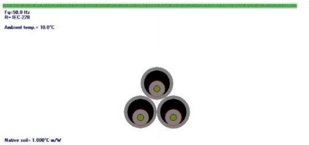
Rysunek 14. Układ analizowanego systemu kabli elektroenergetycznych; kable w przepustach rurowych: ułożenie trójkątne, rezystywność cieplna gruntu rodzimego 1,0 (K·m)/W, temperatura otoczenia (gruntu rodzimego) 10 °C
