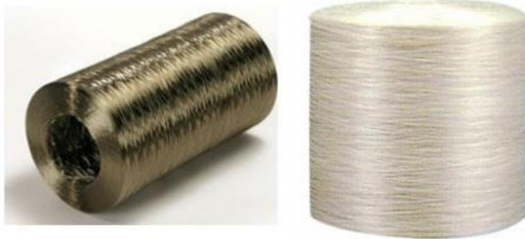
Rysunek 8. Roving włókna węglowego i włókna szklanego.
