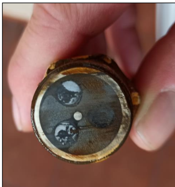
Rysunek 33. Zdjęcie kuponu z wody stojącej.
