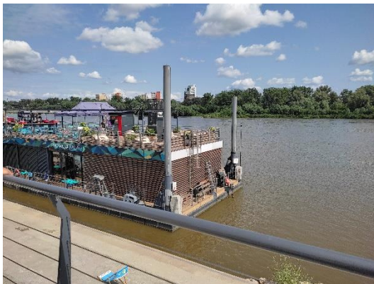
Rys. 3.67. Pale opuszczane na dno, podczas przemieszczania kładzone na specjalnych łożach, Bulwary Wiślane, Warszawa. (Miszevska, 2021)
