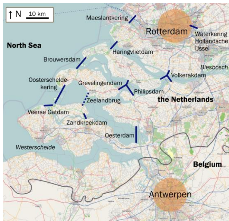
Rys. 3.2. System zabezpieczeń przeciwpowodziowych i sztormowych powstałych w ramach planu Delta na terenie Holandii. (OpenStreetMap.org i Classical geographer, 2008)
