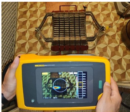
Rys. 4. Przykład lokalizacji koncentracji WNZ kamerą akustyczną Fluke ii900 dla oryginalnego eksploatowanego uzwojenia
