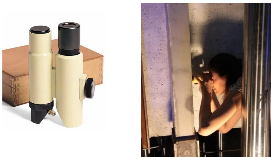
Rys. 4.27 Mikroskop optyczny i pomiar szerokości rys podczas badań.
