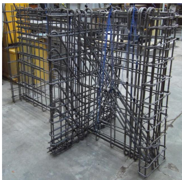
Rys. 4.7 Zbrojenie układu tarczowego DB II-0.5 .
