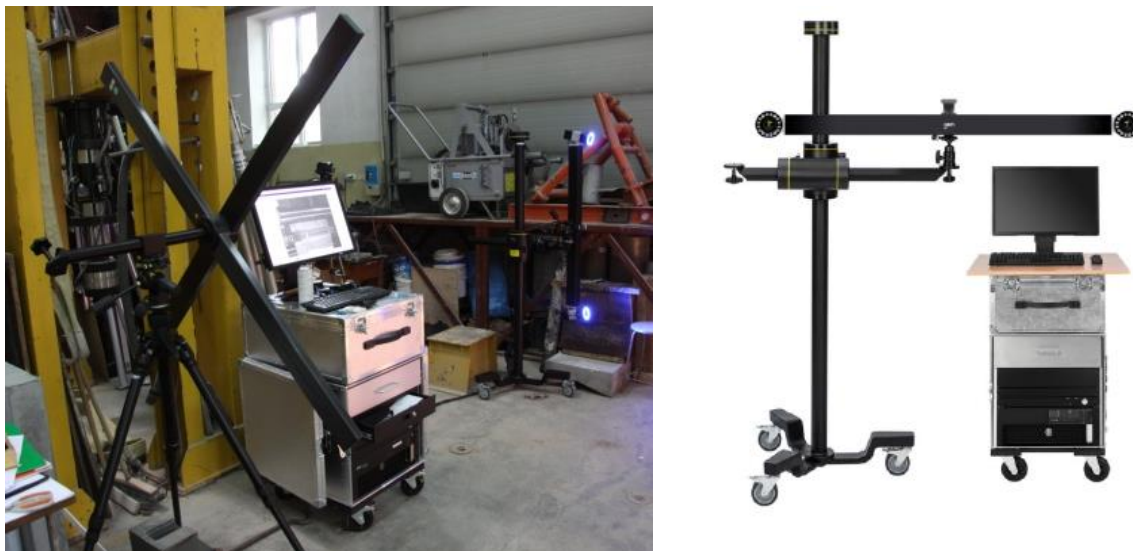
Rys. 4.25 Widok wzorca kalibracyjnego oraz głowicy pomiarowej 3D (układ dwóch kamer)
