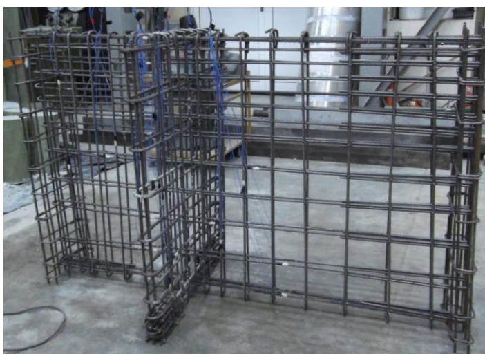
Rys. 4.6 Zbrojenie układu tarczowego DB I-0.5 .
