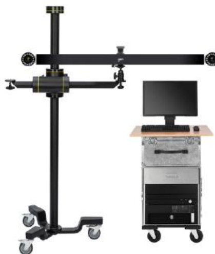
Rys. 4.25 Widok wzorca kalibracyjnego oraz głowicy pomiarowej 3D (układ dwóch kamer)
