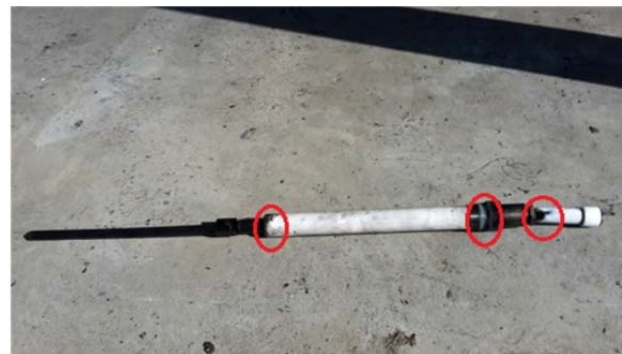
Rys. 2. Uszkodzony izolator przepustowy z demontażu po 2 latach eksploatacji w elektrodehydratorze.
