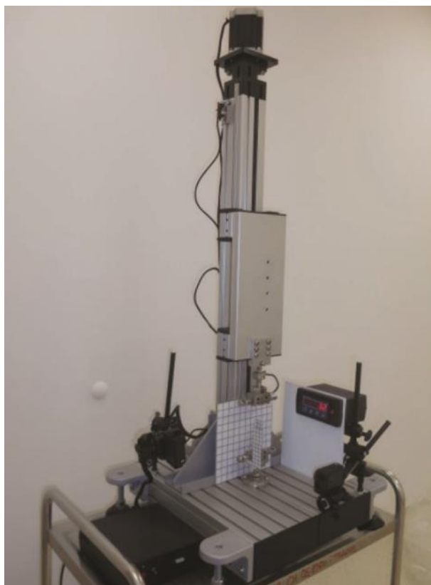
Rys. 10.1. Maszyna do ściskania i rozciągania tkanek [181]
