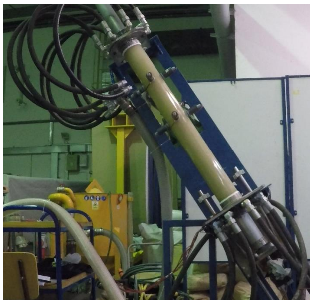
Rysunek 63 Pochylenie osi stanowiska o 30°
