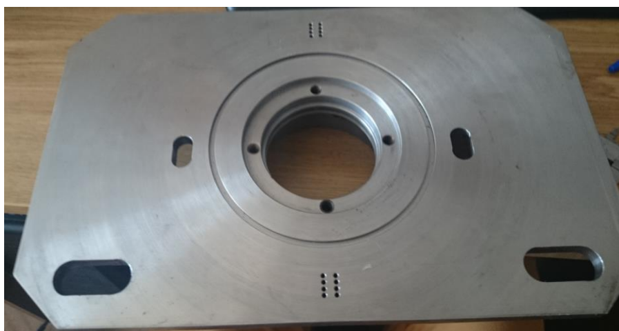
Rysunek 62 Wyfrezowany główny element komory odprowadzającej
