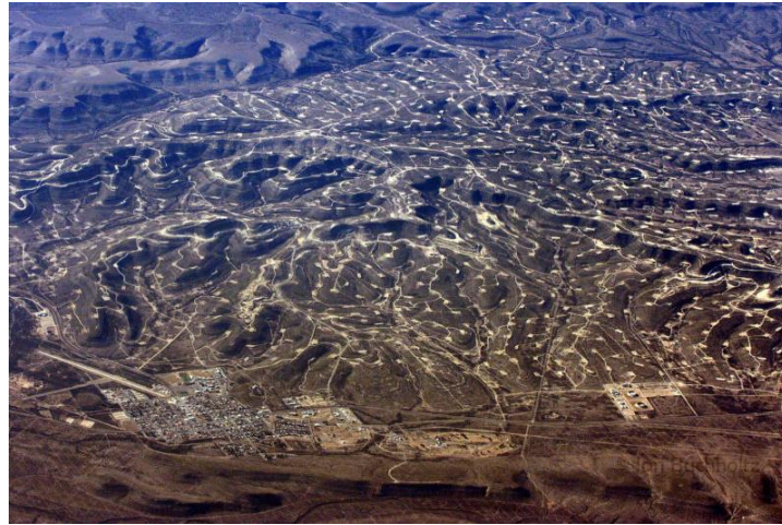
Rysunek 9 Eksploatowane złożo Yates w USA [20] jasne plamy to widoczny wyrównany teren gdzie znajdują się głowice przeważnie dla 6 odwiertów
