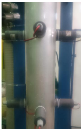
Rysunek 51 Zdjęcie stanowiska badawczego obrazujące rozstaw konduktometrów (sond SI 3013) na stanowisku badawczym
