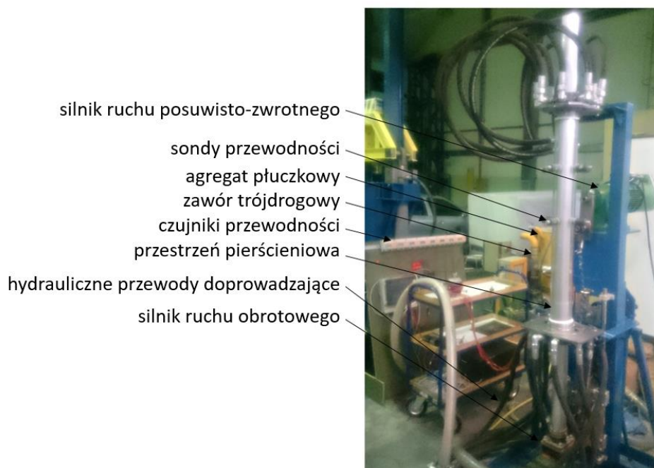
Rysunek 59 Zbudowane stanowisko badawcze
