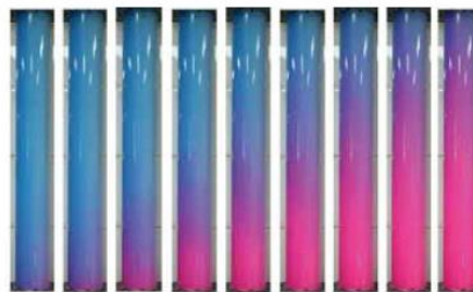
Rysunek 28 Proces wypierania cieczy w ecentrycznej przestrzeni pierścieniowej a) bez rotacji wewnętrznej rury, b) z rotacją wewnętrznej rury wynoszącą 10 obrotów na minutę, c) z rotacją wewnętrznej rury wynoszącą 20 obrotów na minutę [57]
