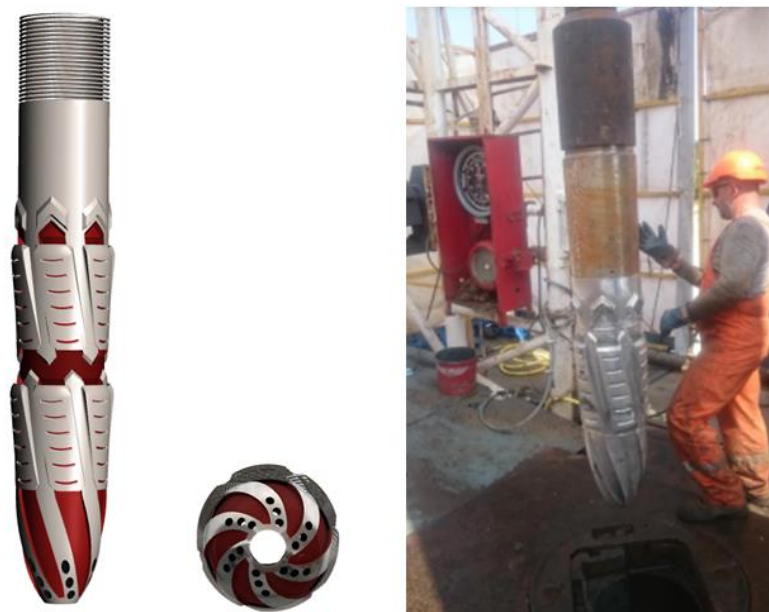
Rysunek 102 Wizualizacja opracowanego buta cementacyjnego i gotowe urządzenie podczas testów na odwiercie głębokim
