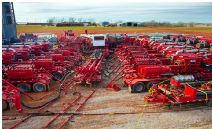
Rysunek 36 Agregaty szczelinujące [66]
