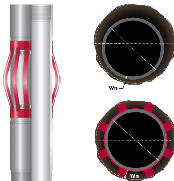
Rysunek 44 Wizualizacja budowy i umieszczenia jednego z typów centralizatorów obecnie stosowanego w przemyśle wydobywczym [73]
