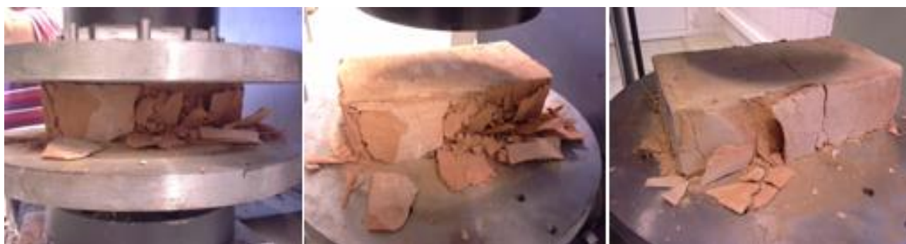
Rys. 43 Badanie cegieł pełnych
