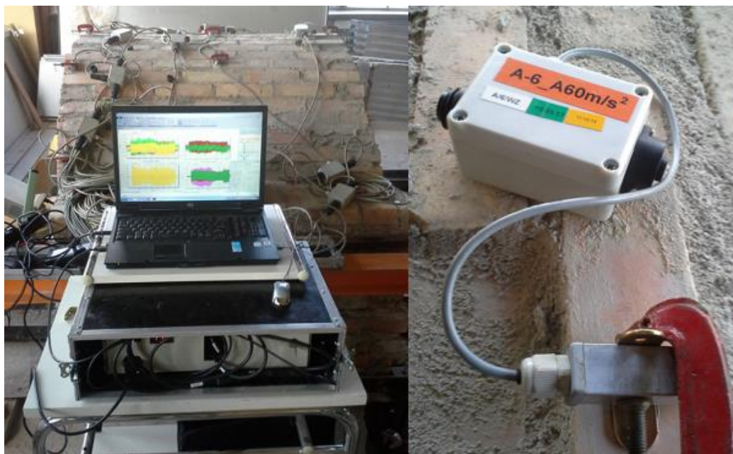
Rys. 48 Wzmacniacz i komputer rejestrujący przyspieszenia oraz akcelerometr.
