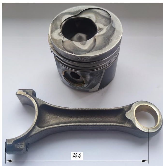
Rys. 8.3. Tłok i korbowód modelowanego silnika AJM 1.9 TDI
