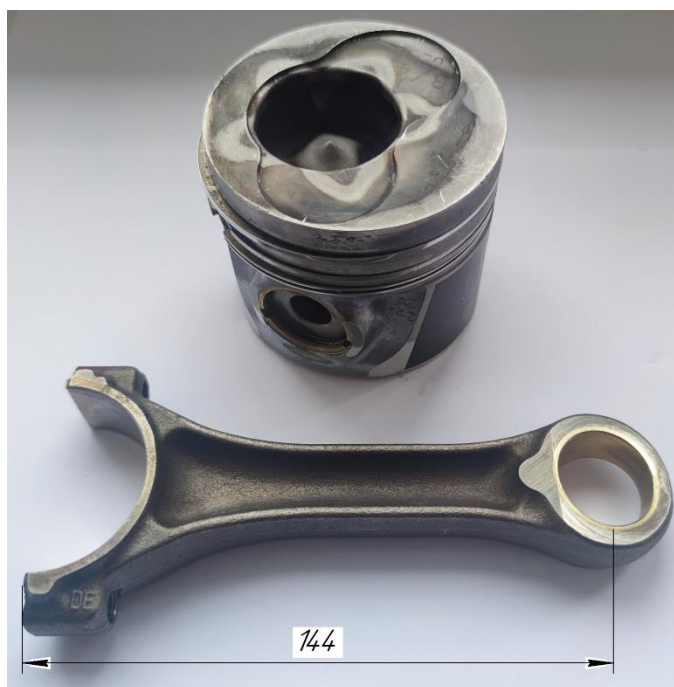
Rys. 8.3. Tłok i korbowód modelowanego silnika AJM 1.9 TDI
