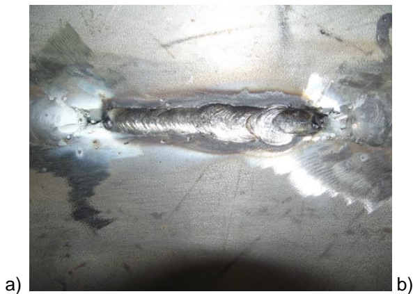
Rys. 104. Widok spoin próbnych w próbce 1TBM wykonanej elektrodami Böhler (a), oraz próbki LTM wykonanej elektrodami Lincoln Electric (b) w sztucznej wodzie morskiej
