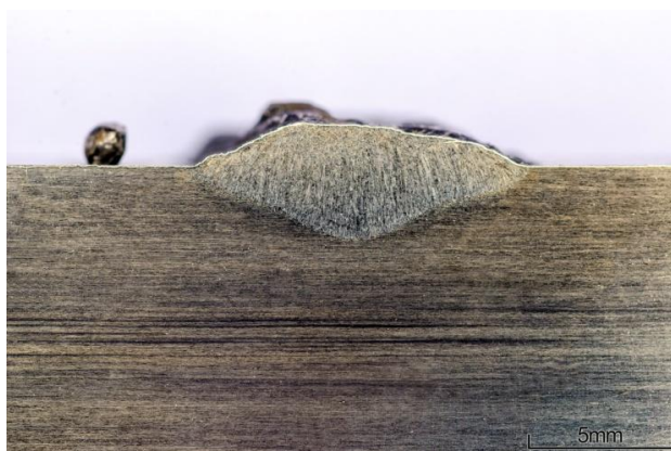
Rys. 64. Przekrój poprzeczny napoiny BWN3-2, q_l=0,93 kJ/mm, DC (-)
