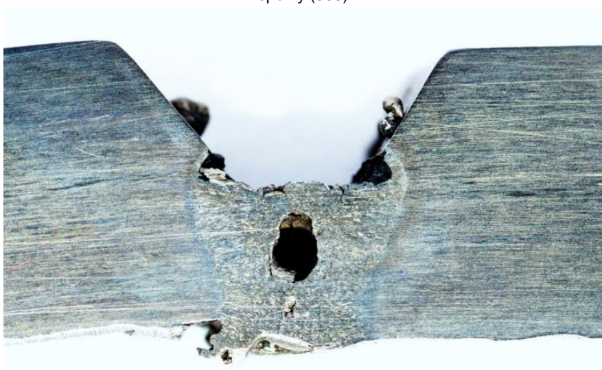
Rys.126. Przekrój złącza próbnego 2ZLS2 spawanego w wodzie wodociągowej elektrodami Lincoln Electric. Brak pęknięć. Ujawnione niezgodności: pęcherz gazowy (2011), wyciek (504), podtopienie ciągłe (5011), nieregularna powierzchnia (514), rozprysk (602)
