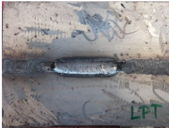
Rys. 105. Widok spoin próbnych w próbce TBP wykonanej elektrodami otulonymi Böhler (a) oraz próbki TLP wykonanej elektrodami Lincoln Electric (b) na powietrzu
