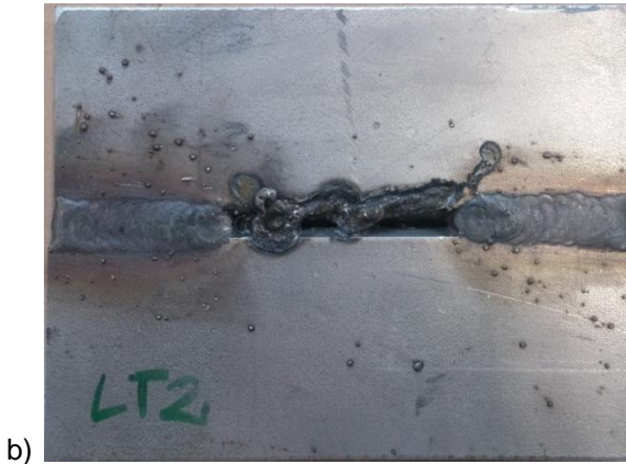
Rys. 104. Widok spoin próbnych w próbce 1TBM wykonanej elektrodami Böhler (a), oraz próbki LTM wykonanej elektrodami Lincoln Electric (b) w sztucznej wodzie morskiej
