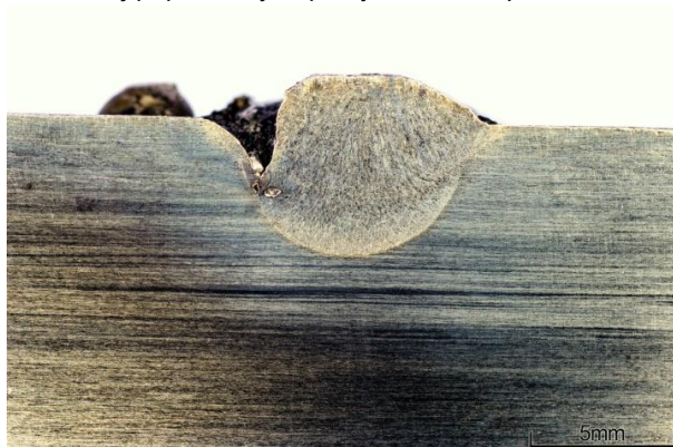
Rys. 67. Przekrój poprzeczny napoiny BWN2-2, q_l=0,93 kJ/mm, DC (-)
