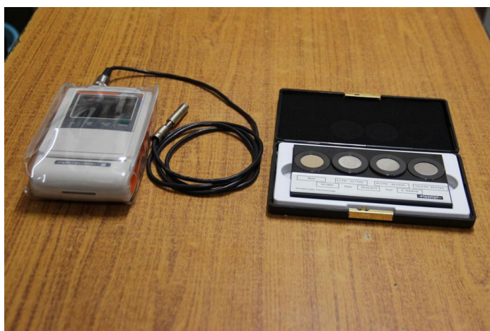
Rys. 53. Widok przenośnego ferrytoskopu Fisher MP30
