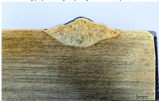
Rys. 70. Przekrój poprzeczny napoiny BWN12-1, q_l=0,93 kJ/mm, DC (+)
