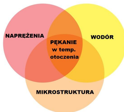
Rys. 25. Diagram czynników wpływających na powstawanie pęknięć zimnych [88]
