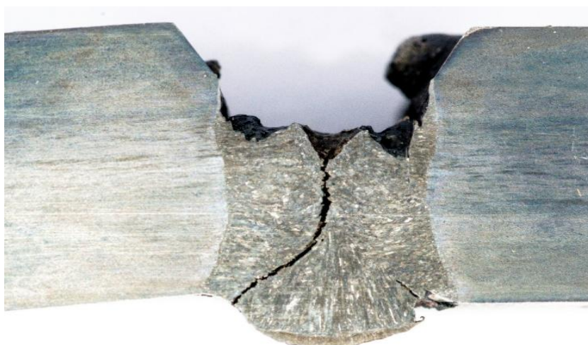
Rys.129. Przekrój złącza próbnego 2LZM3 spawanego w sztucznej wodzie morskiej elektrodami Lincoln Electric. Widoczne pęknięcie w osi spoiny oraz inne niezgodności: wyciek (504), podtopienie ciągłe (5011), nieregularna powierzchnia (514), przesunięcie liniowe (502)
