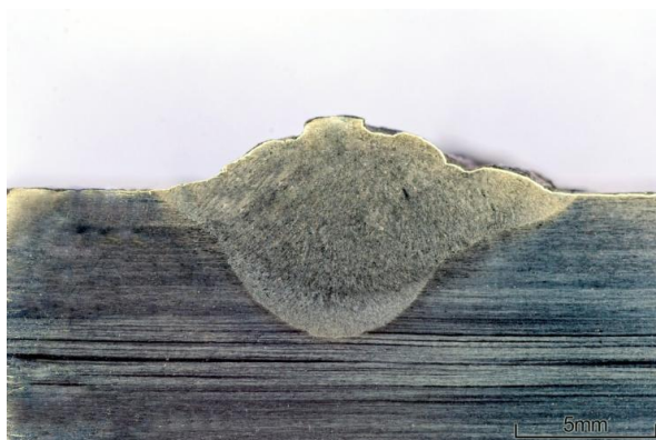
Rys. 67. Przekrój poprzeczny napoiny BWN2-2, q_l=0,93 kJ/mm, DC (-)
