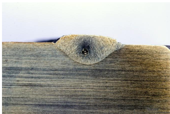
Rys. 69. Przekrój poprzeczny napoiny BWN9-1, q_l=0,90 kJ/mm, DC(-)
