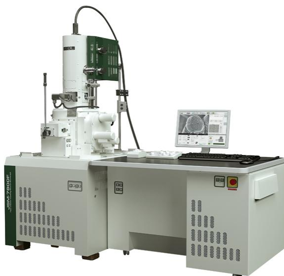
Rys.54. Elektronowy mikroskop skaningowy JSM-7800F [171]
