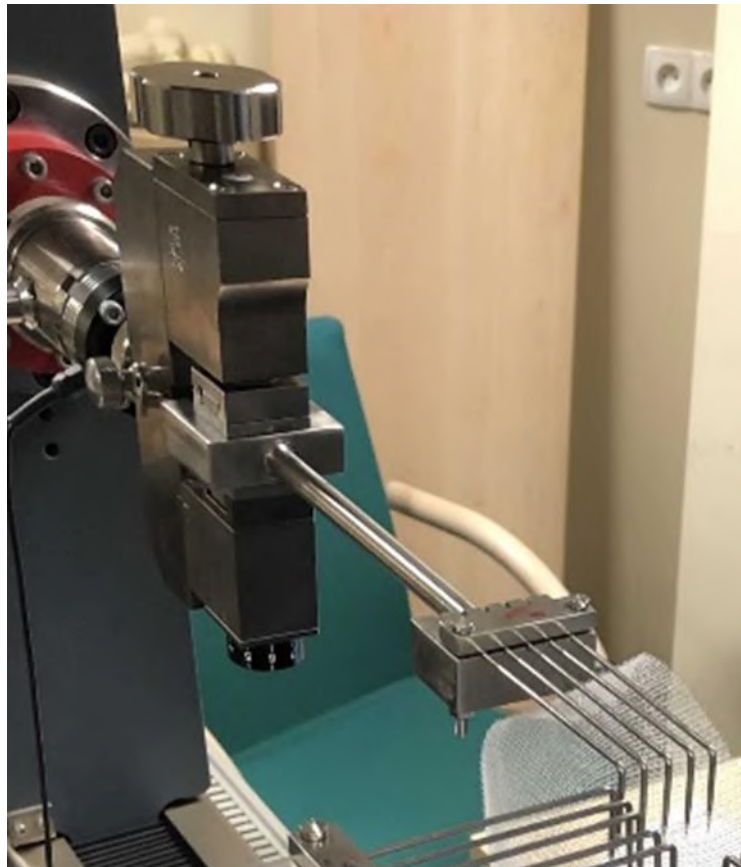
Rys. 4.3. Widok wykonanego uchwyty, zamocowanego w maszynie wytrzymałościowej, z implantem nałożonym na igły
