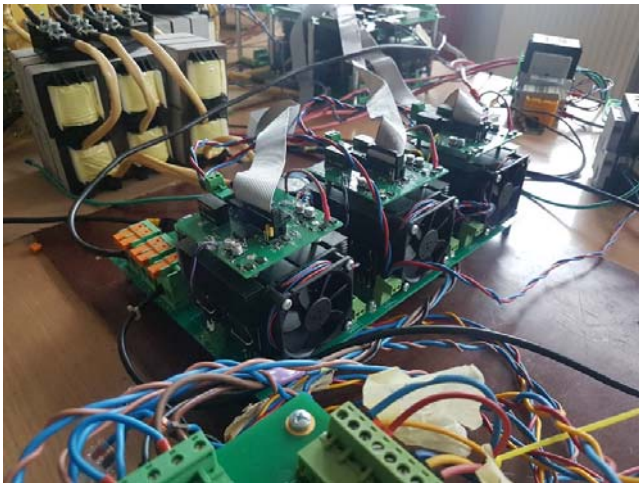
Rys.7. Moduł przekształtnika (bez płyty sterującej)
