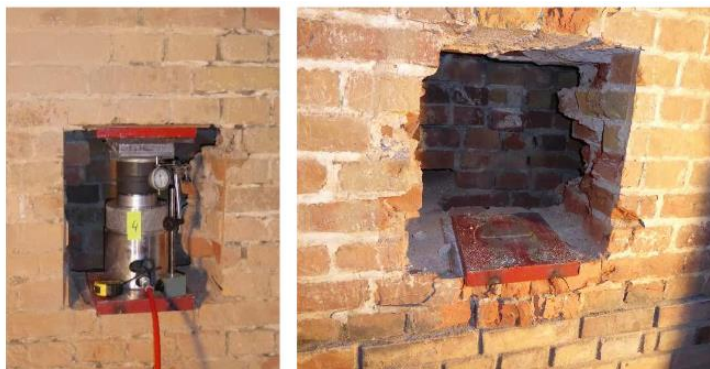
Rys. 13 Metoda badania wytrzymałości murów zaproponowana przez Tkacza i Orłowicza [169]
