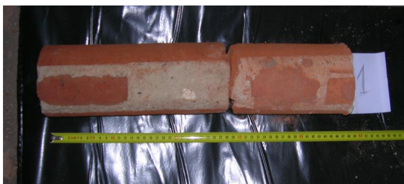
Rys. 7 Odwiert rdzeniowy pobrany do badań ze ściany XII wiecznego kościoła (fot. Tomasz Majewski)
