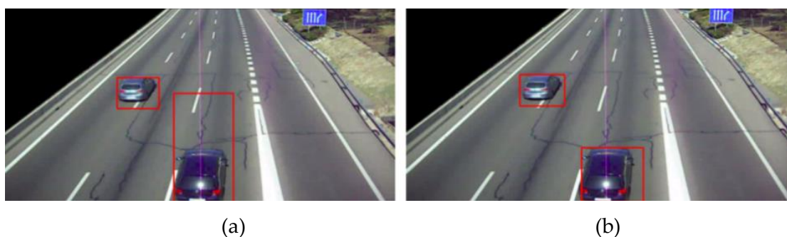
Rys. 37. Klasyfikacja pojazdów na podstawie nagrania wideo z algorytmem odejmowania tła (rys. (a)) oraz z zastosowaniem sieci neuronowej (rys. (b)).
