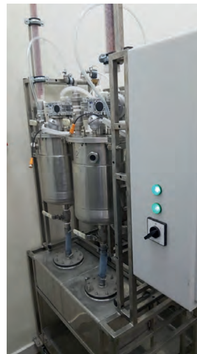
Fig. 1. Anaerobic digestion research station Rys. 1. Stanowisko badawcze fermentacji anaerobowej
