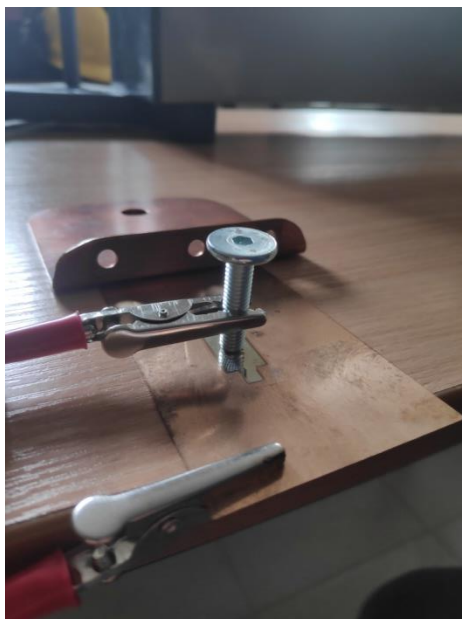
Rys. 5.12. Stanowisko do badania wytrzymałości elektrycznej
