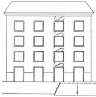
Rys. 2-33. Rysy ściany wskutek nierównomiernego osiadania [124]
